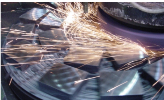
Płaszczyzny szlifowane planetarnie Surface planetary ground
