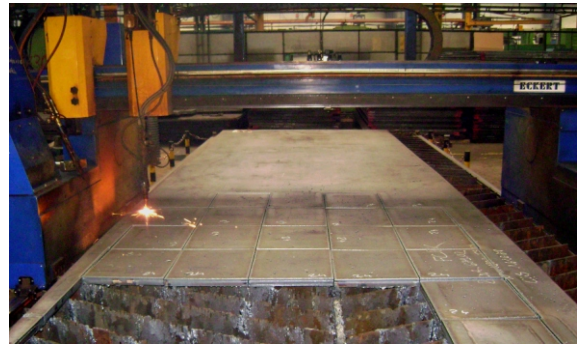
Obrysy cięte palnikiem CNC gas cut edges
